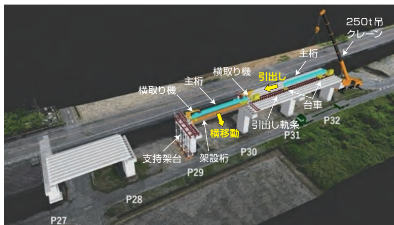
図-5 主桁の引出し・横移動(3次元モデル)
