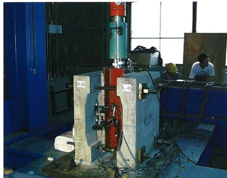
▲押し抜き試験
