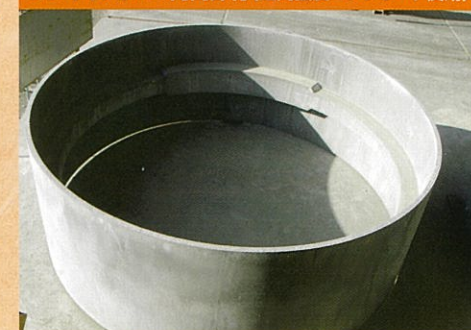
プレキャストPC円筒部材(超高強度コンクリート使用)
