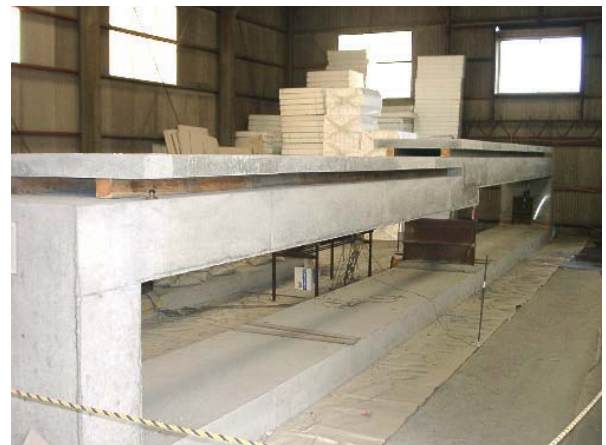
長期荷重実験状況
