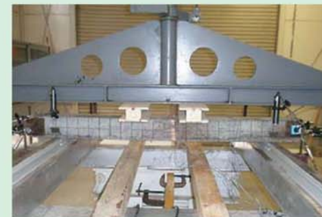
高強度コンクリートを使用した PCはりの曲げ載荷試験
