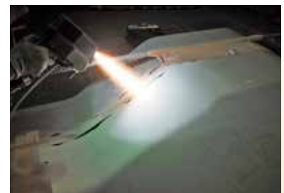
写真-4 プラズマ溶射状況
