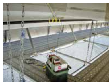
写真-4 固有振動数計測状況
