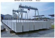
品質の保証されたJIS工場で桁を製作します。JIS桁には、「T桁」・「ホロー桁」と呼 ばれる2種類の桁があります。
