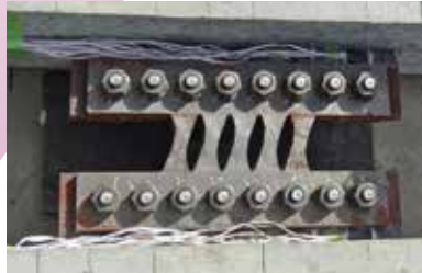
ダンパの実験状況 ( R=1/82\text{rad.} )
