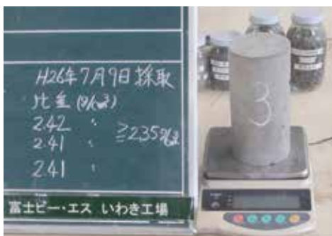
写真-1 コンクリート比重 検査状況
